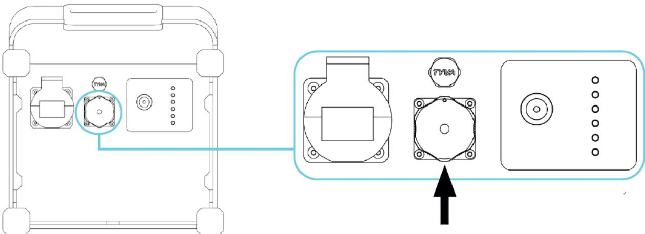
Il n'est pas nécessaire d'allumer la station d'énergie à l'avance pour pouvoir la recharger. Elle se mettra en route automatiquement une fois le câble de charge branché, et s'éteindra aussitôt le câble de charge débranché. Si la PowerCase est déjà allumée au moment de brancher le câble, elle le restera lorsque celui-ci sera retiré.
