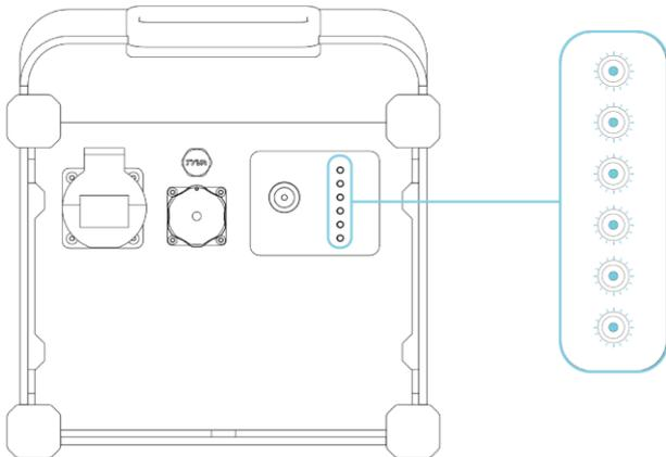
Un afficheur LED est disposé sur la face avant de la PowerCase. Il est composé de 6 voyants permettant d'indiquer le niveau de charge du système :
